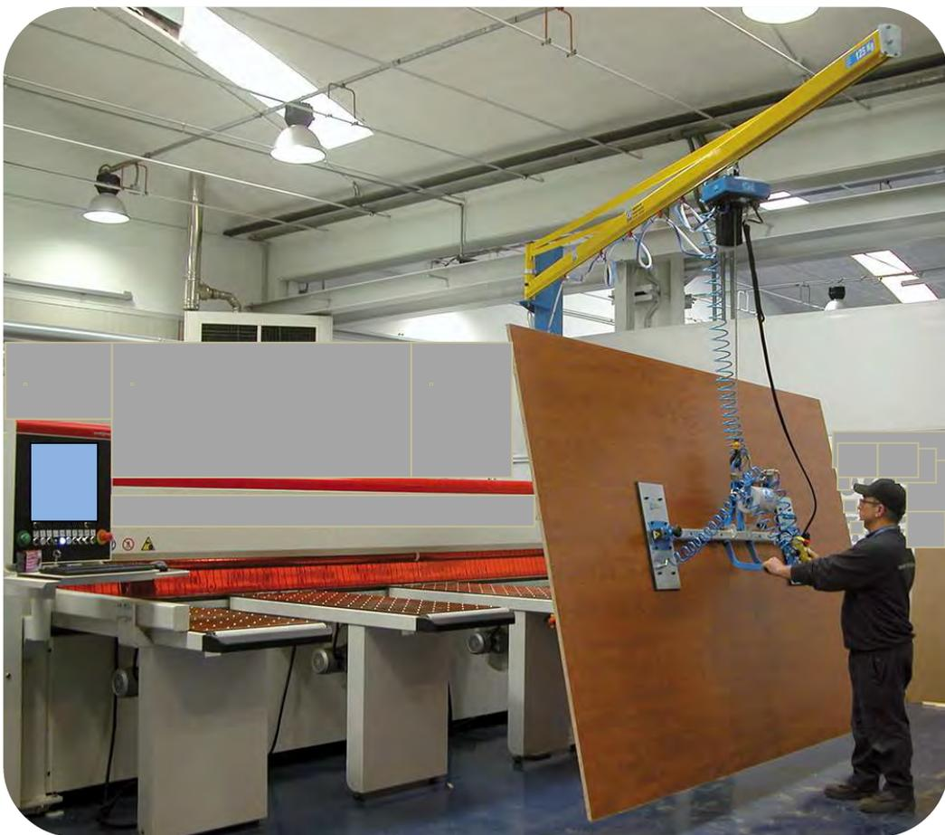
Impianto di sollevamento per la movimentazione di pannelli in legno laminato, truciolare mdf, composto da gru a bandiera in versione con colonna e braccio di lunghezza 6 mt, corredata di paranco elettrico a catena, e ventosa a 2 piastre con alimentazione ad aria compressa
