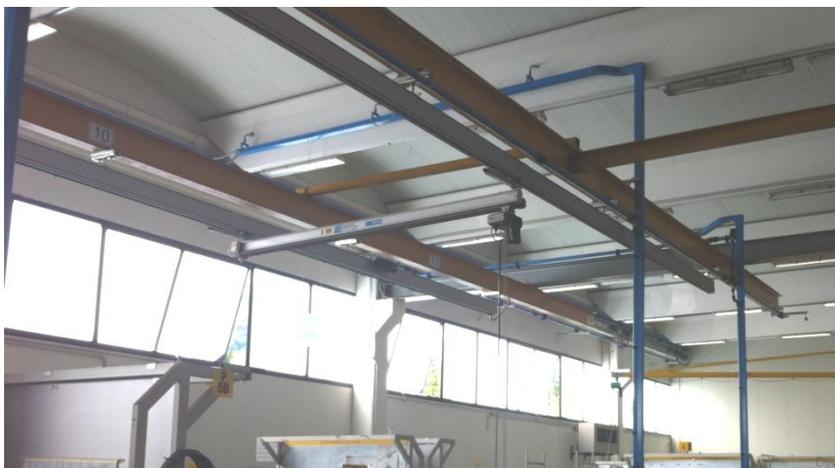
**Strutture aeree con gru a ponte sospese**
